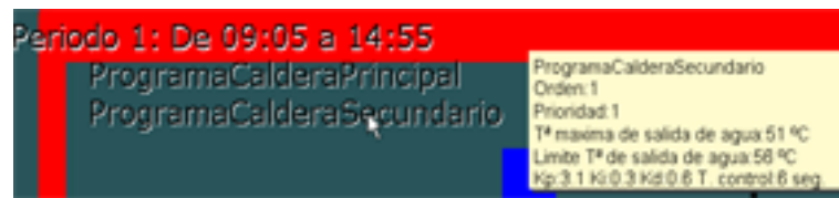
Figura 2.20: Parametros de calefacción de un programa secundario
